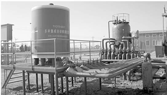
多井集成自动掺液装置现场照片
