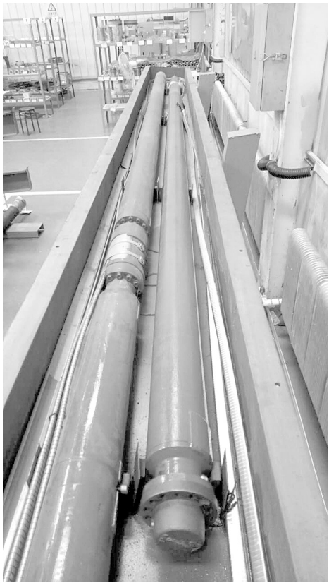
高温电潜泵工作原理及样机
