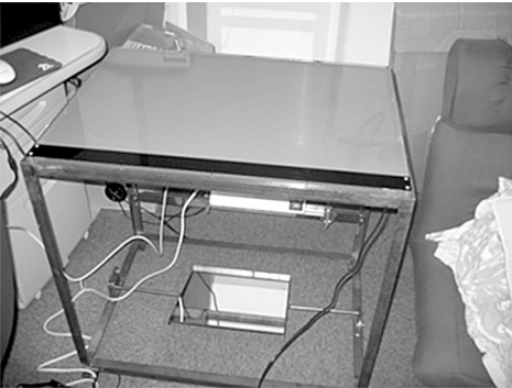
图4 基于FTIR技术的多点触摸平台效果图
